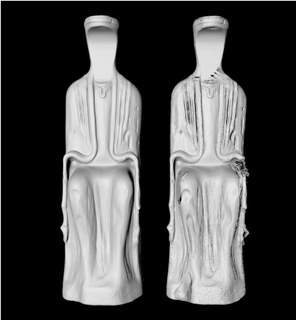
Figura 7-9. Incorrecta aplicación de mapa de normales en piezas con pocos niveles de subdivisión.
