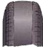
Presión de Aire excesiva
