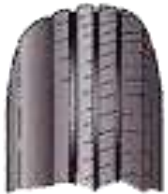
Desgaste por caída
