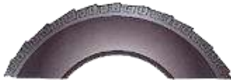
Desgaste diagonal Desgaste del talón y En punta
