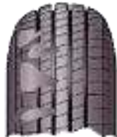
Desgaste irregular (Varios problemas)
