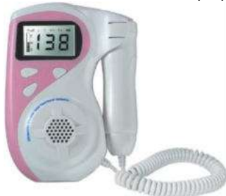
Figura 2. Doppler obstétrico. Este aparato, que funciona mediante efecto doppler, permite la detección de los latidos cardíacos fetales, desde las 12 semanas en adelante. Muchos de estos equipos tiene un visualizador que muestra de modo automático la frecuencia cardíaca fetal.
