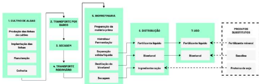
Figura 9. Sistema de produto (biorrefinaria de macroalgas). Fonte: Traduzido de Seghetta et al. (2016).
