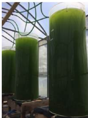
Figura 2. Fotobiorreator utilizado no Laboratório de Produção de Microalgas da Estação Marinha de Aquicultura - FURG.
