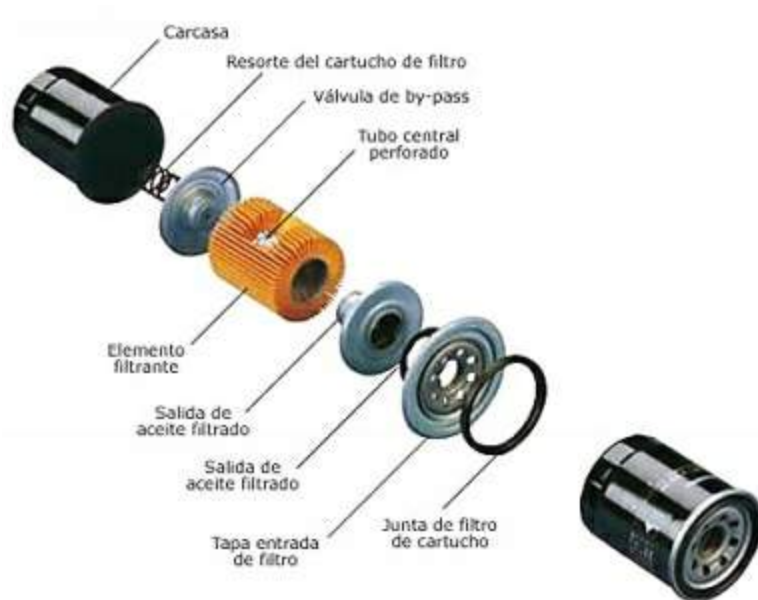
Despiece de un filtro desechable
