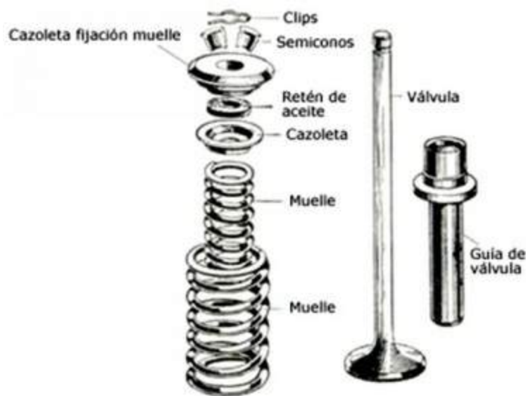
Componentes de la válvula
