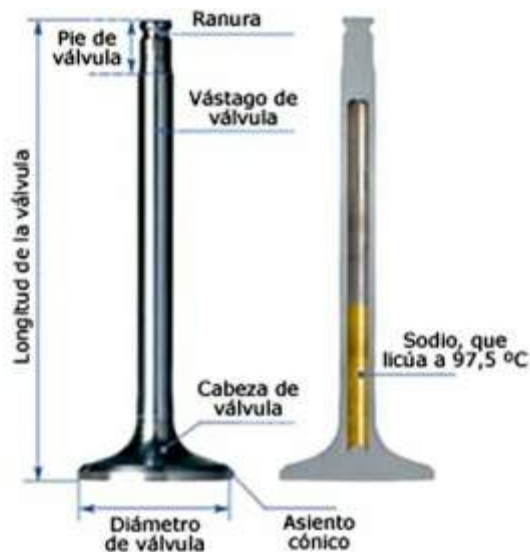
Esquema de una válvula de escape refrigerada por sodio
