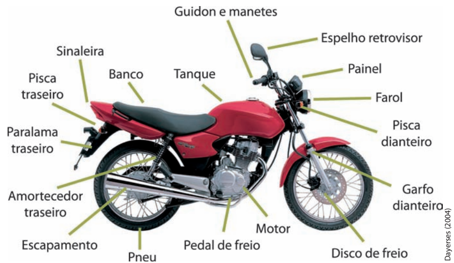
Figura 13 - Principais características de uma moto
