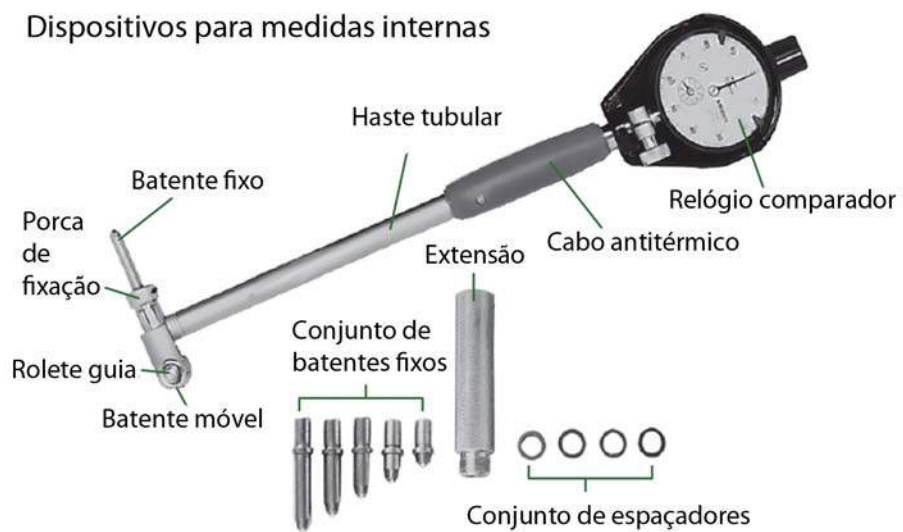
Figura 47 - Relógio comparador Fonte: Adaptado de SENAI (2006, p. 81)
