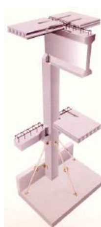
Figura 84: Esquema de ligações típicas de estruturas pré-fabricadas (Fonte: FIB, CEB-FIP, 2002)
