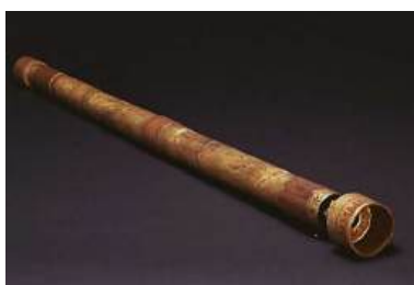
Figura 28.3: Réplica do telescópio de Galileo de 3 cm de diâmetro.
