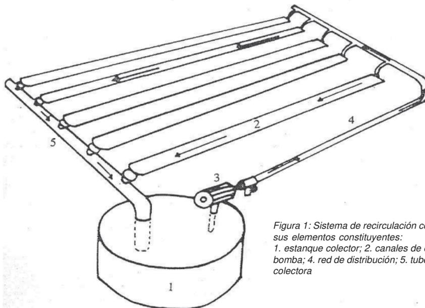
Figura 1: Sistema de recirculación continua y sus elementos constituyentes:
