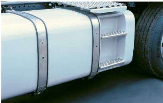
Fig. 1-4 Depósito y escaleras
