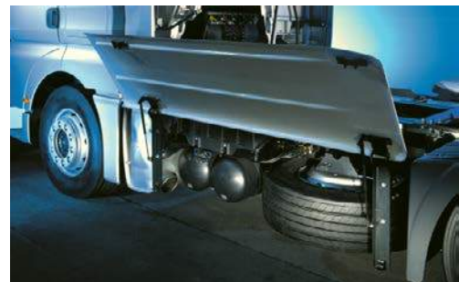
Fig. 1-8 Colocación depósitos de aire comprimido y rueda de repuesto
