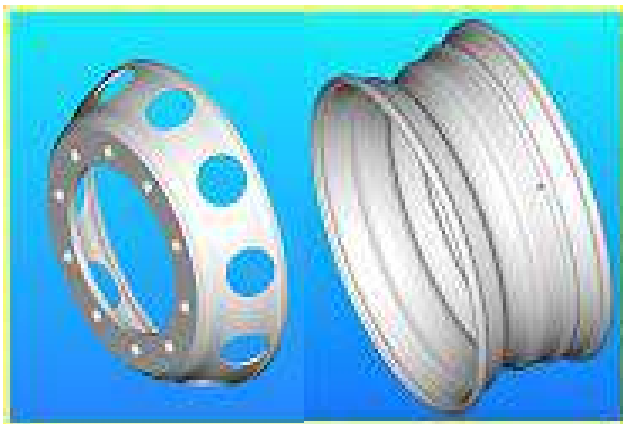
Fig. 8-5 Composición de la llanta
