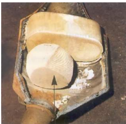
Fig. 4-11 Desgaste y rotura del catalizador
