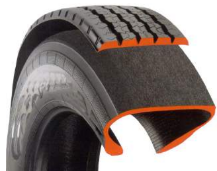
Fig. 8-17 Aplicación de una nueva banda
