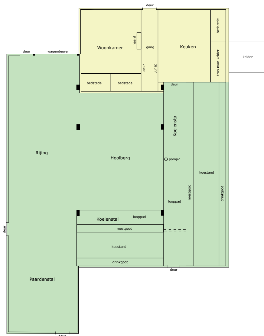
Afbeelding 77. Gereconstrueerde plattegrond van Akenbuurt 12 rond 1900. Schaal 1:150, in groen de werkruimtes, in geel de woonvertrekken.
