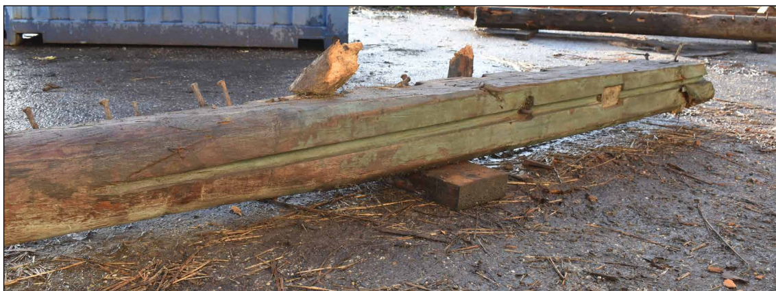
Afbeelding 58. Rechthoekig deel van het rondhout met de halfronde gleuf.
