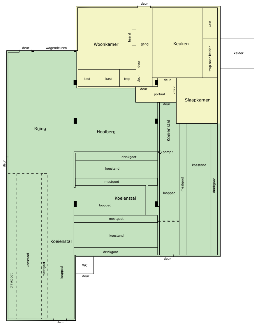
Afbeelding 79. Gereconstrueerde plattegrond van Akenbuurt 12 rond 1950. Schaal 1:150, in groen de werkruimtes, in geel de woonvertrekken.
