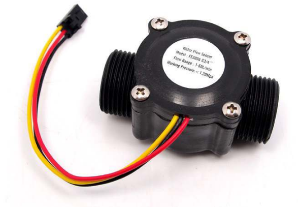
Figura 2 - Sensor de fluxo controlado com Arduino (Próprio autor).
