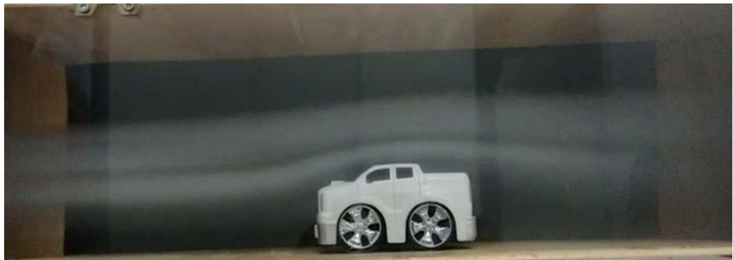
Figura 25 – Visualização de escoamento em um carro de brinquedo.
