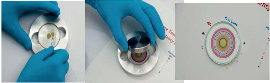
Figura 2. Características de separação do óleo. Fonte: SKF (2011).
