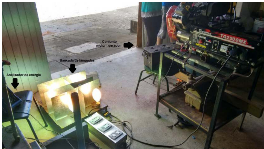
Figura 2. Estrutura montada para os testes.
