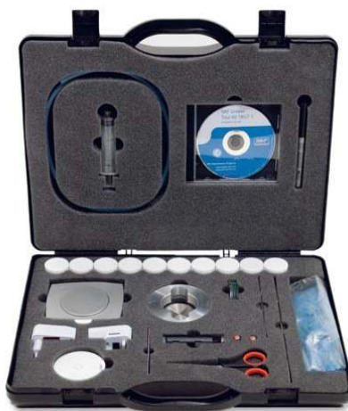
Figura 1. Kit de Teste para Graxa TKG1 da SKF. Fonte: SKF (2011).
