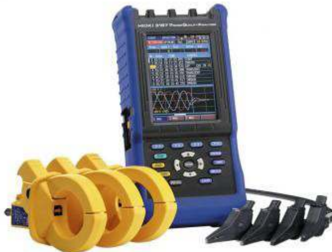
Figura 4. Analisador de qualidade de energia portátil. Fonte: GETROTECH (2016)
