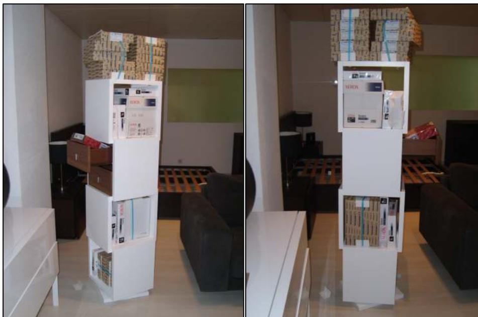
Figura 37 – Teste de qualidade/resistência à estante shell <sup>55</sup>
