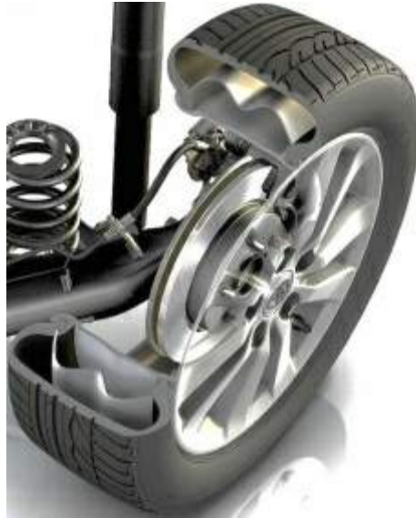
Corte de una rueda: Neumático, llanta y disco
