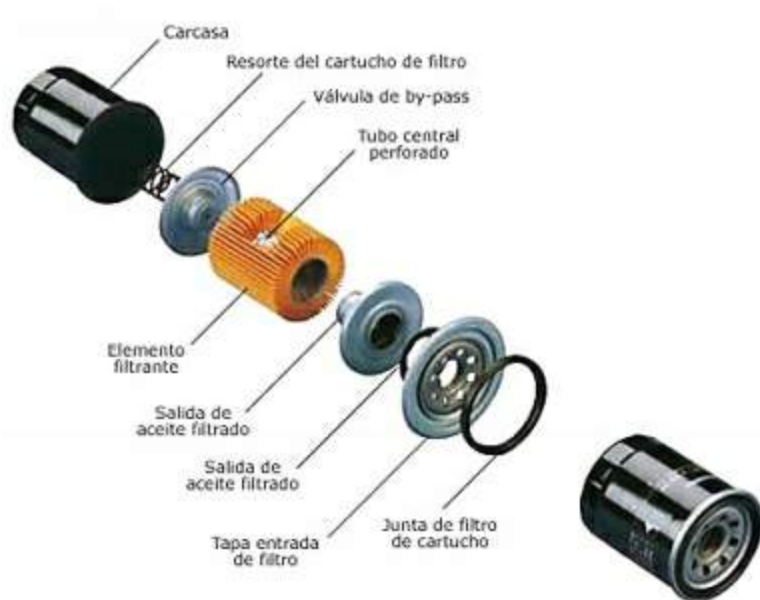
Despiece de un filtro desechable
