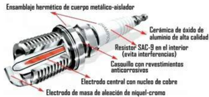
Partes de una bujía
