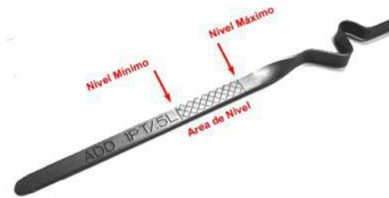
Detalle varilla de medición del aceite en el cárter
