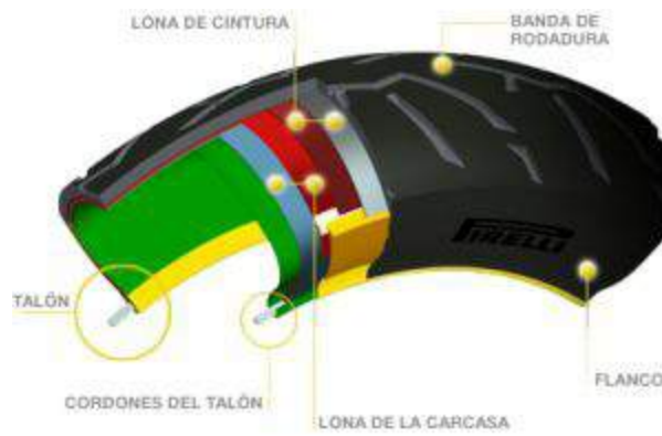
Partes de un neumático
