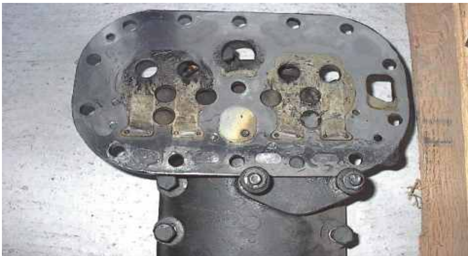
Figura 7.3. - Plato de válvulas con un sobrecalentamiento
