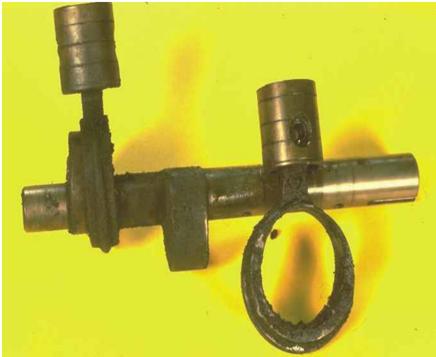
Figura 7.1.- Corrosión y lodos en partes del compresor.
