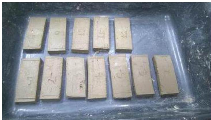
**Figura 2.** Corpos de prova após secagem a 110°C.
