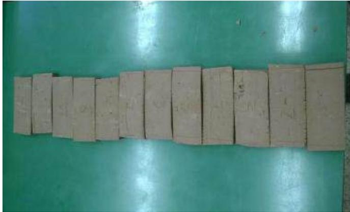
**Figura 3.** Corpos de prova após queima a 950°C.
