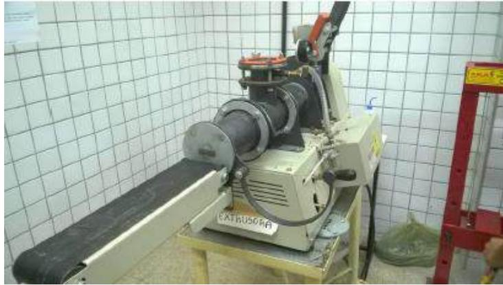
**Figura 1.** Extrusora – Laboratório de ensaios cerâmicos/IFPI.
