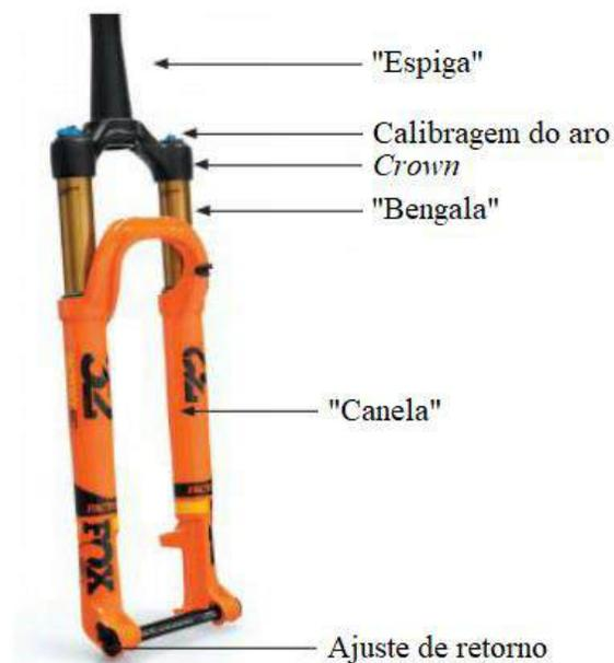
**Figura 3** – Partes componentes de suspensão dianteira analisada.
