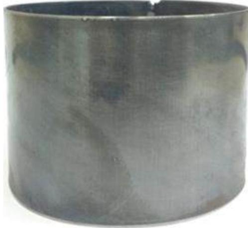
**Figura 2** – Imagem do cátodo oco de aço inox.
