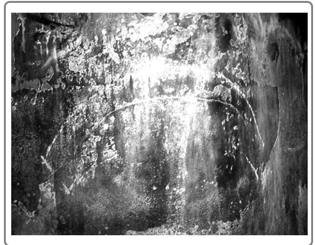
Figura 1-11 Revelador para líquido fluorescente posemulsificable, aplicado a una placa metálica y visto con lámpara ultra violeta
