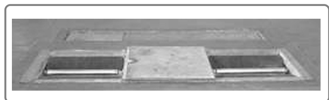
Figura 1-9 Rodillos del frenómetro sobre los que se colocan las llantas del automóvil
