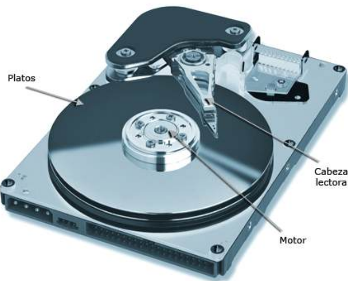
Figura 23 Partes del disco duro (35)
