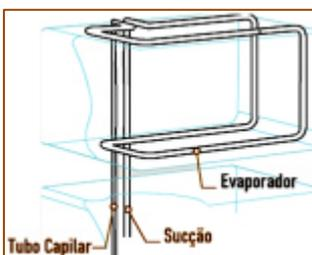
**EVAPORADOR:** recebe o fluido refrigerante proveniente do tubo capilar, no estado líquido a baixa pressão e baixa temperatura. Nesta condição, o fluido evapora absorvendo o calor da superfície da tubulação do evaporador, ocorrendo a transformação de líquido sub resfriado para vapor saturado a
