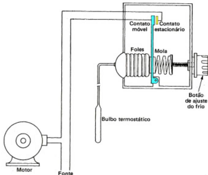
Ilustração simplificada mostrando os princípios de funcionamento de um sistema de bulbo e foles de controle de temperatura.
