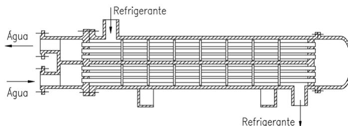
quantidade de tubos horizontais e paralelos, conectados a duas placas dispostas em ambas as extremidades. A água de resfriamento circula por dentro dos tubos e o refrigerante escoo dentro da carcaça, em volta dos tubos. Os tubos são de cobre e os espelhos de aço para hidrocarbonetos halogenados e, para amônia, tanto os tubos como
