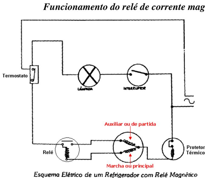
Quando o motor atinge de 70 a 80% de sua rotação nominal, a intensidade da corrente diminui e com isso também diminui o fluxo do campo magnético no relé, por esta razão, as armaduras com platinados descem, retomando a sua posição inicial e desligando a bobina auxiliar. O motor, enquanto estiver energizado, segue trabalhando com o enrolamento de marcha, que é a bobina principal.
