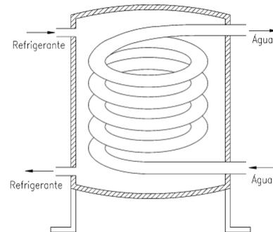
de produtos químicos (solução com 25% de HCl em água, com inibidor). São usados em unidades de pequena e média capacidade, tipicamente até 15 TR.
