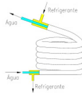
está em contato com a superfície externa do tubo de maior diâmetro. Estes condensadores são normalmente utilizados em unidades de pequena capacidade, ou como condensadores auxiliares operando em paralelo com condensadores a ar, somente nos períodos de carga térmica muito elevada. Esses condensadores são difíceis de se limpar e não fornecem espaço suficiente para a separação de gás e líquido.
