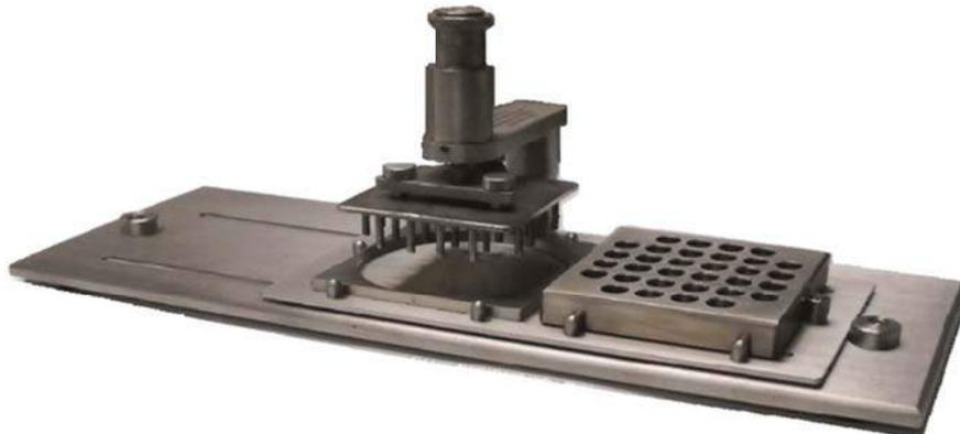
**Figura 1.** Replicador de Steers. En la placa cuadrada se colocan los inóculos bacterianos tomados por las puntas que se ven por debajo del mango. Esas puntas se mueven verticalmente, como para mojarse con los inóculos y, al desplazarse la base, inocular las placas, que tendrán concentraciones crecientes del antibiótico incorporadas.
