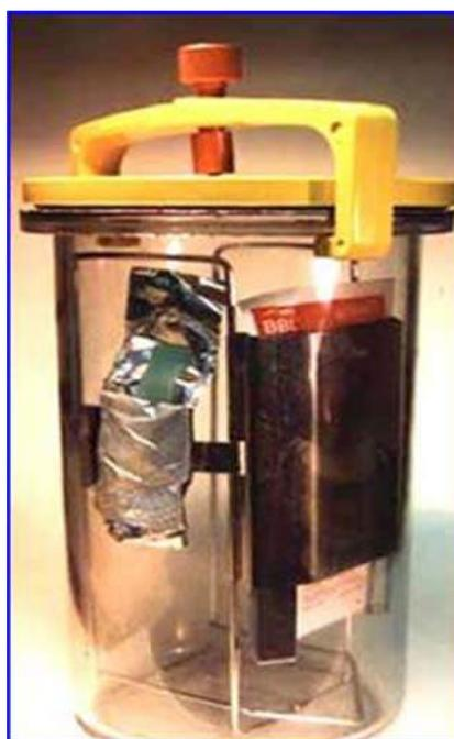
Figura 2. Jarra anaeróbica con generador.
