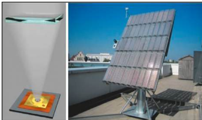
Figura 2.16 Exemplo de sistemas de concentração fotovoltaica usando lentes Fresnel para concentrar a luz solar (Philipps, Bett, Horowitz, & Kurtz, 2015)
