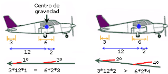
Fig.1.6.9 - Desarrollo de la estabilidad longitudinal.
