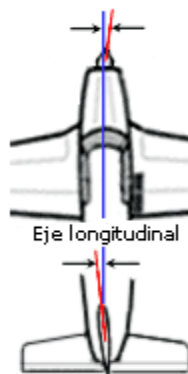
Fig.1.9.3 - Diseños que reducen la guiñada adversa.
