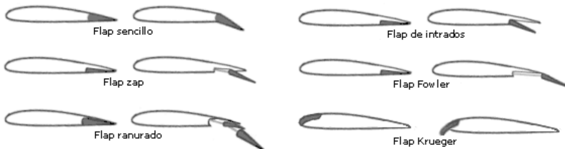
Fig.1.5.9 - Distintos tipos de flaps.
