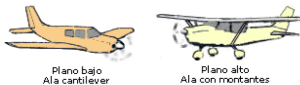
Fig.1.4.6 - Colocación y sujeción al fuselaje.
