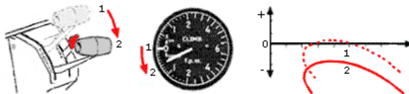
Fig.1.10.4 - Efecto de disminuir potencia (cortar gases).
