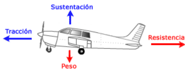
Fig.1.3.1 - Fuerzas que actúan en vuelo.
