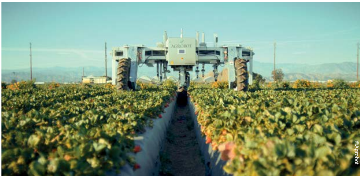
Figura 9. Robot agrícola especializado para la recolección de fresas
