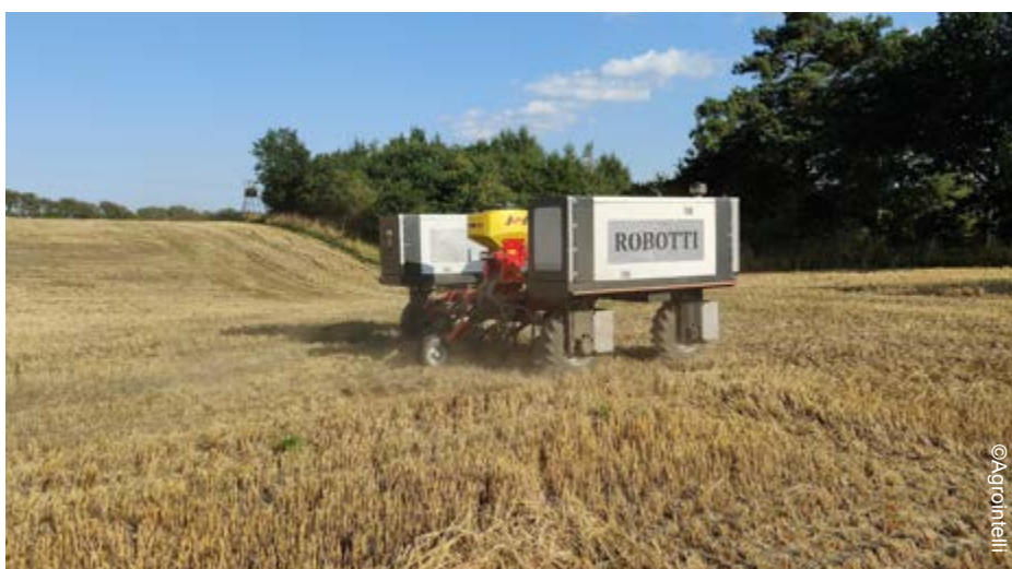
Figura 7. Plataforma autoalimentada (Agrointelli, Dinamarca)
