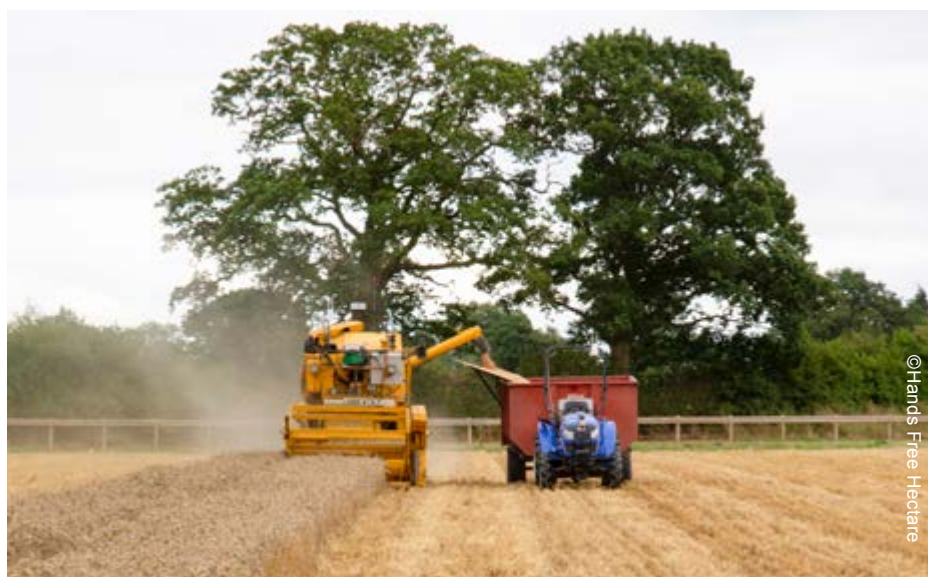
Figura 11. Proyecto “Hands Free Hectare” (Hectárea de manos libres): una cosechadora de la década de 1980 y un pequeño tractor convencional de cuatro ruedas que arrastra un remolque
