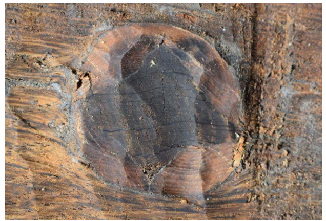
Afb. 90. Ronde houten pen in de huidplank, met daarin een vierkant wigje.
