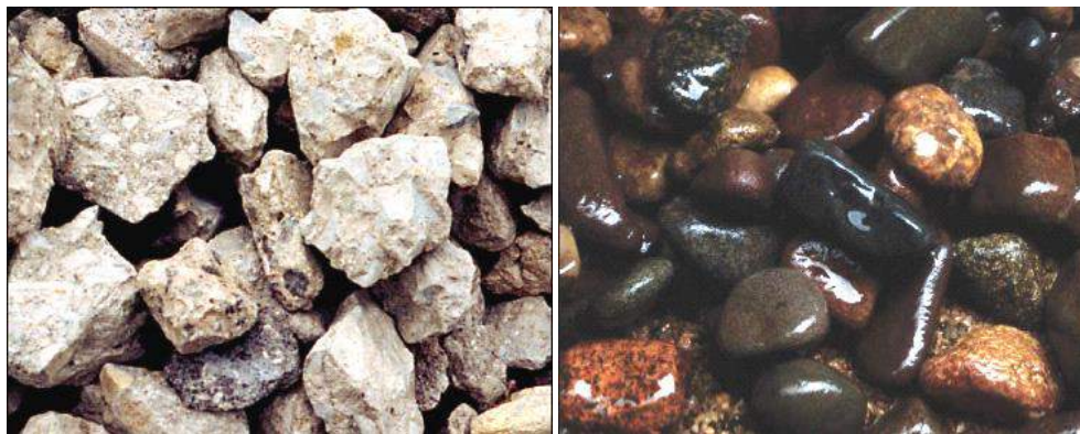
Figure 2.1: La forme des granulats.
