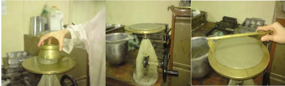
a) Remplissage du moule b) application des coups et étalement c) mesure des diamètres
