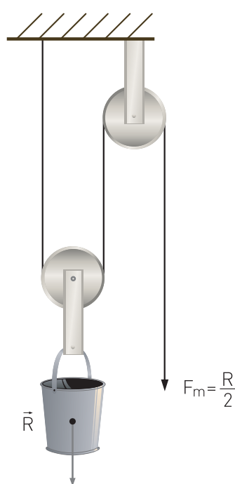
↑ Combinación de polea fija y polea móvil.
