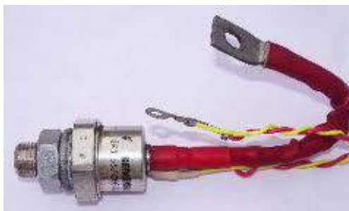
Figura 13 – Aspecto físico do SCR de potência
