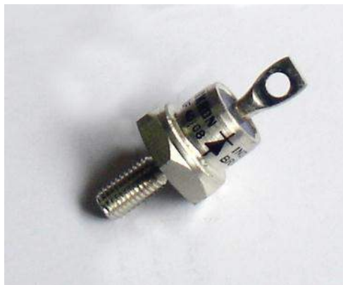
Figura 05 – Aspecto físico do diodo de potência
