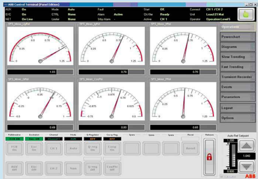
4 Sistema de excitación UNITROL 6000 con convertidores que emplean cajas de controlador basado en PP D104
