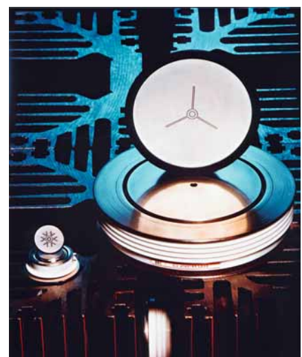
Obleas de silicona y revestimientos de un tiristor de 38 x 127 mm para 5,5 kv (1983)
