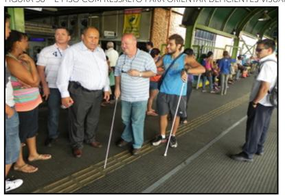
FIGURA 58 – E PISO COM RESSALTO PARA ORIENTAR DEFICIENTES VISUAIS
