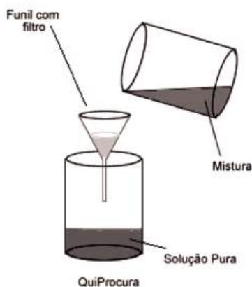
Figura 4.9 – Filtração de uma mistura sólido-líquido.
