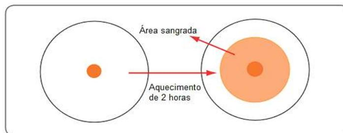
**Figura 3.** Área sangrada após o aquecimento. Fonte: SKF (2011).
