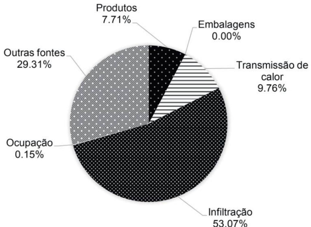
**Figura 4.** Distribuição das fontes de cargas térmica.
