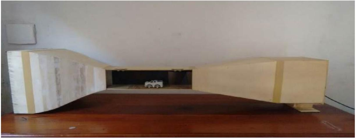
Figura 19 - Mini Túnel de Vento construído.
