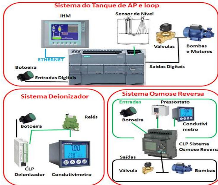
Figura 10. Arquitetura descentralizada da ETA antes da adequação.
