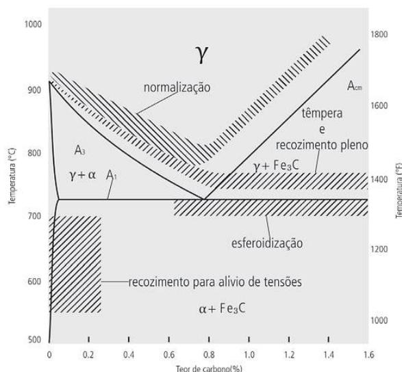
Figura 1: Temperaturas de tratamentos térmicos de ligas Ferro-Carbono, (VALE, 2007).
