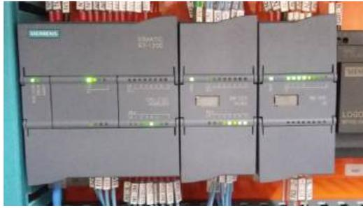
**Figura 6.** CLP Siemens S7-1200 e módulos adicionais conectados via barramentos laterais.
