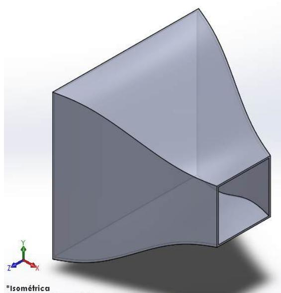
Figura 4 - Modelagem do bocal de contração.
