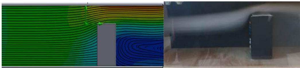
Figura 22 – Comparação da análise computacional e experimental do escoamento no bloco.
