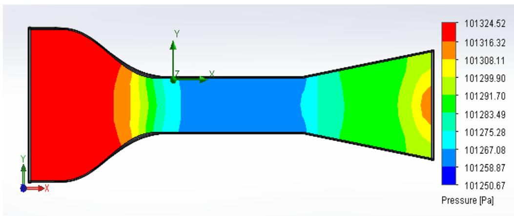
Figura 15 – Análise da pressão no túnel de vento.
