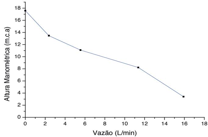
Figura 7 - Curva Característica – Altura Manométrica x Vazão – Bomba BBA 1 (0,5 CV). Fonte: (Próprio autor).
