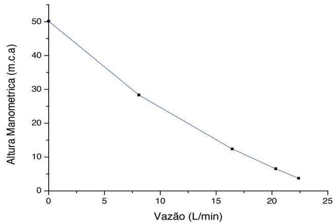
Figura 8 - Curva Característica – Altura Manométrica x Vazão – Bomba BBA 2 (1 HP). Fonte: (Próprio autor).
