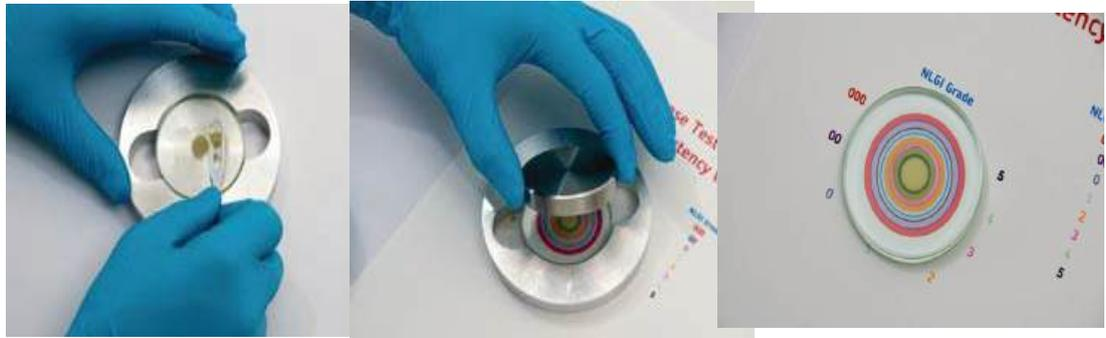
**Figura 2.** Características de separação do óleo. Fonte: SKF (2011).
