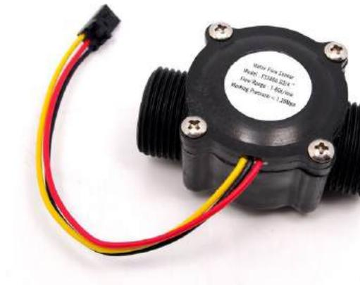
Figura 2 - Sensor de fluxo controlado com Arduino (Próprio autor).
