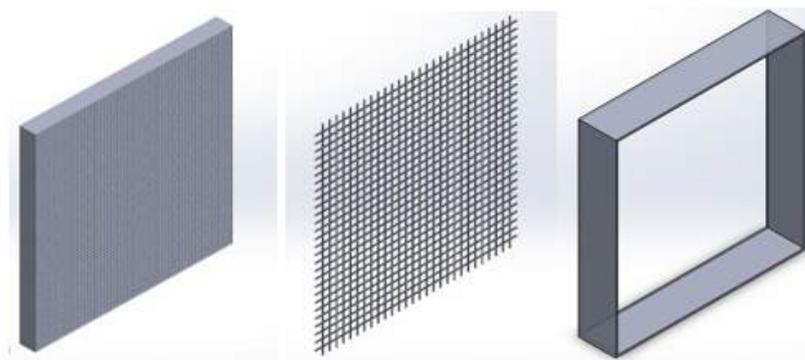
Figura 2 - Modelagem colmeia, tela e seção da câmara
