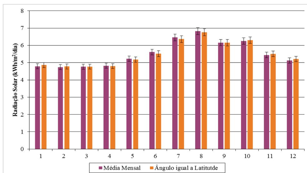
**Figura 3** - Radiação solar diária com inclinação de superfície igual ao ângulo de latitude para Teresina-PI.
