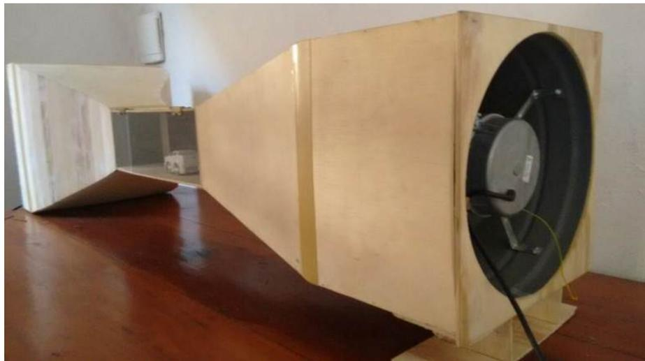
Figura 18 – Vedação na parte final do túnel de vento.
