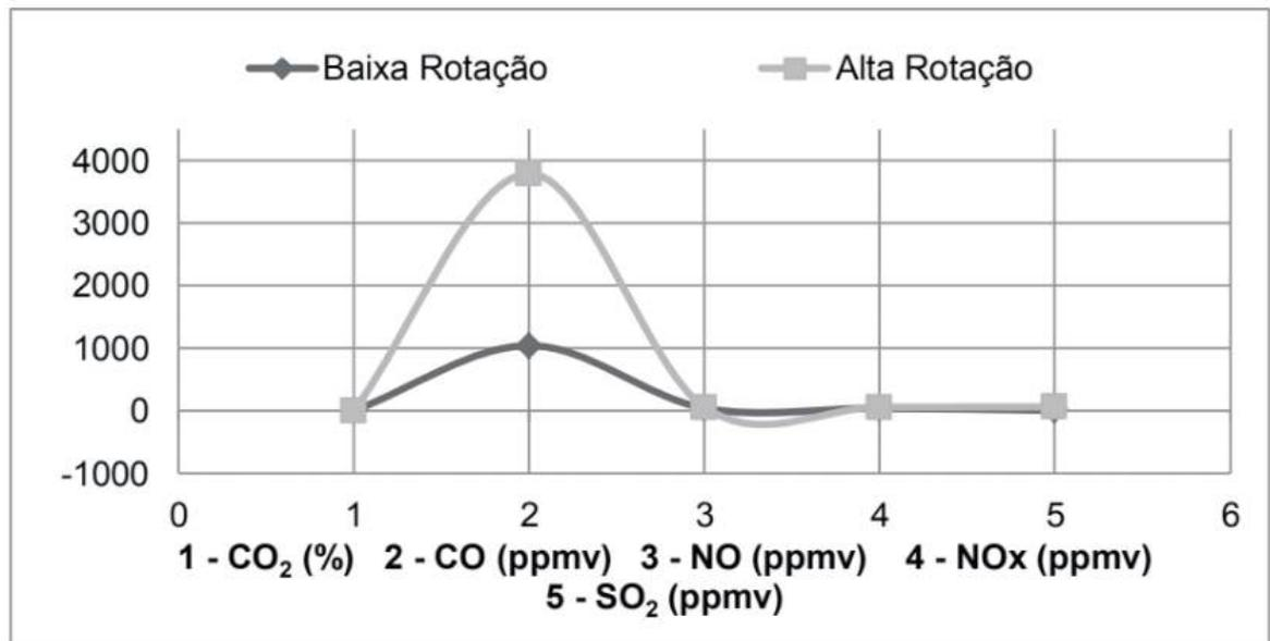
**Figura 4.** Concentração dos gases poluentes da combustão de gasolina comum para dois modos de operação do motor.
