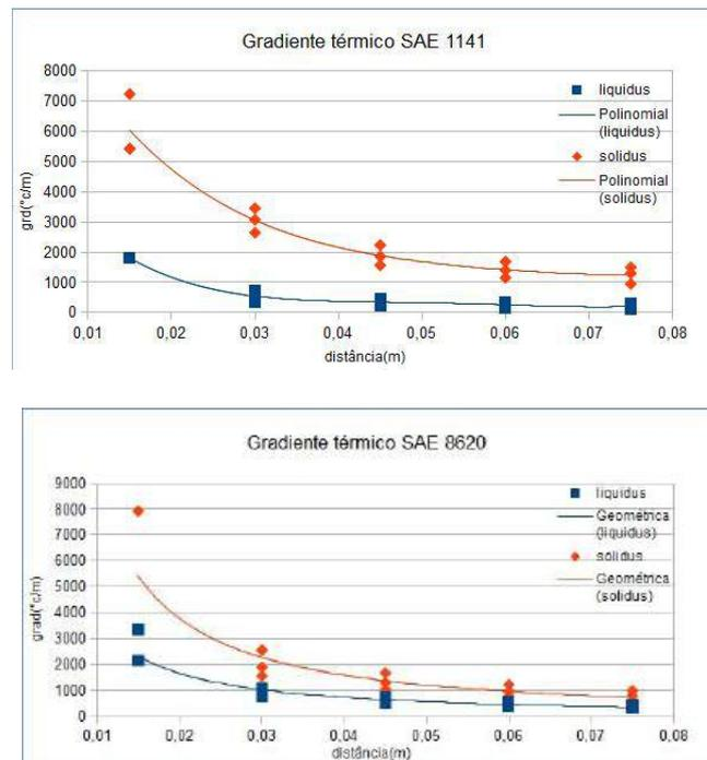
**Figura 5.** Gradiente térmico calculado para cada qualidade de aço estudado
