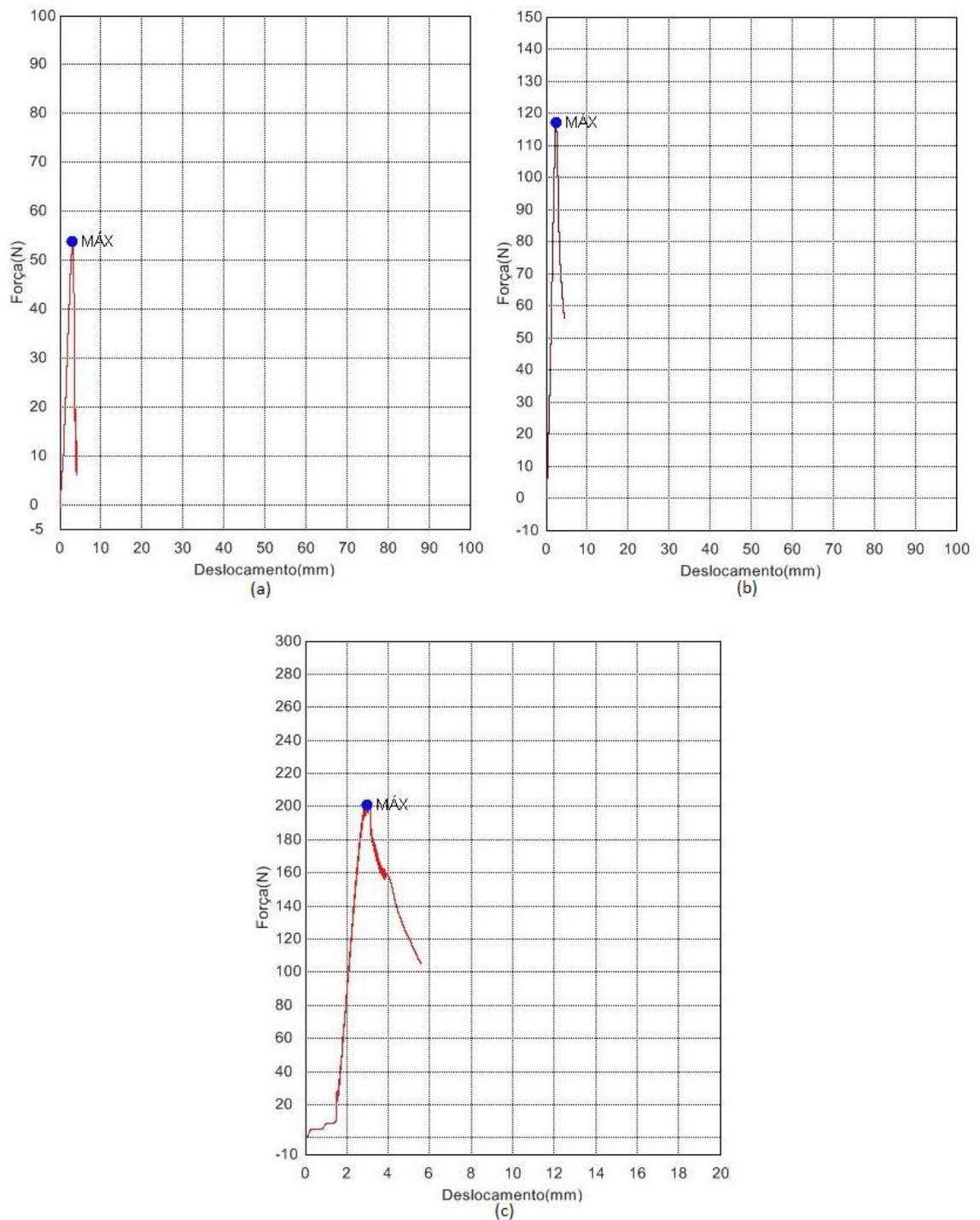
Figura 4. Curvas força-deslocamento obtidas através do ensaio de dobramento com madeira balsa sem reforço (a), com reforço de fibra de vidro (b) e fibra de carbono (c).
