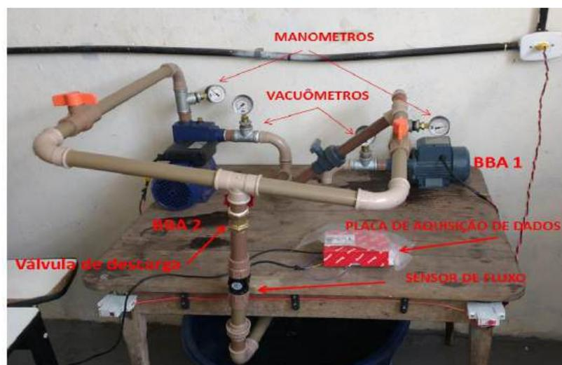
Figura 6 - Configuração final da unidade experimental (Próprio autor).
