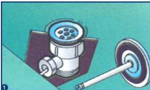
Dreno com tirante Colocar a barra de elevação com o tirante sobre o lavatório. Colocar o outro tirante metálico no orifício do dreno. Ligar os tirantes entre si através da peça articulada e apertar.
