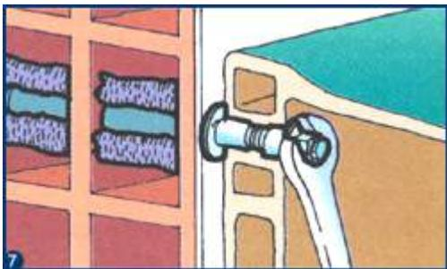
**Instalado com "garras" aparafusadas**
