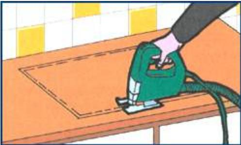
Fazer um ensaio com o lava-louça equipado no local de instalação, onde deverá encaixar-se sem dificuldade. Se necessário desbastar o orifício com uma grossa sem ultrapassar a linha de corte.
