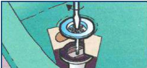
A tampa móvel impede a descarga da água. A tomada de água anti-transbordamento é instalada por baixo antes da instalação do sifão.
