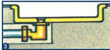
· para encastrar no solo: os bordos da base ficam ao nível do solo. É necessário escavar o solo para fazer a instalação e para o sistema de evacuação das águas (3).
