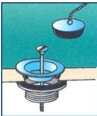
manual com fixação por parafuso
