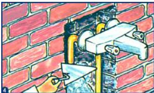
• **Em seguida** desmontar a torneira para fazer o acabamento final da parede. Se a distância entre-eixos das canalizações for diferente do entre-eixos da torneira (misturador) utilizar uniões excêntricas para fazer a ligação (ver abaixo).
