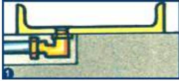
· para pousar: a base é instalada directamente sobre o chão. Deverá ser necessário escavar o chão para instalar o sistema de evacuação das águas (1).
