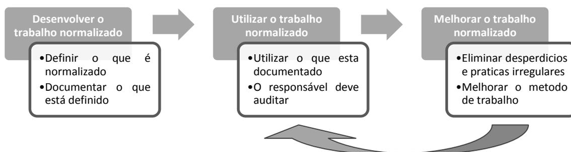
Fig. 3.3- Fases de um processo de trabalho normalizado
