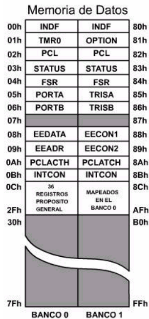
Figura 7.10. Memoria RAM y registros en el PIC16F84 (repetición)
