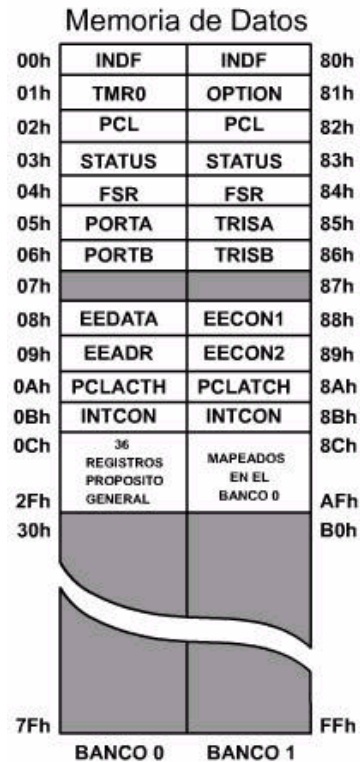
Figura 7.9. Uso de la memoria RAM y registros internos en el PIC16F84
