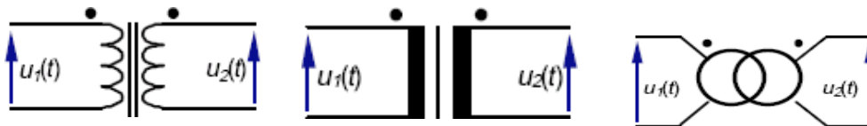
Figure (2.5) : Symbole électrique d'un transformateur
