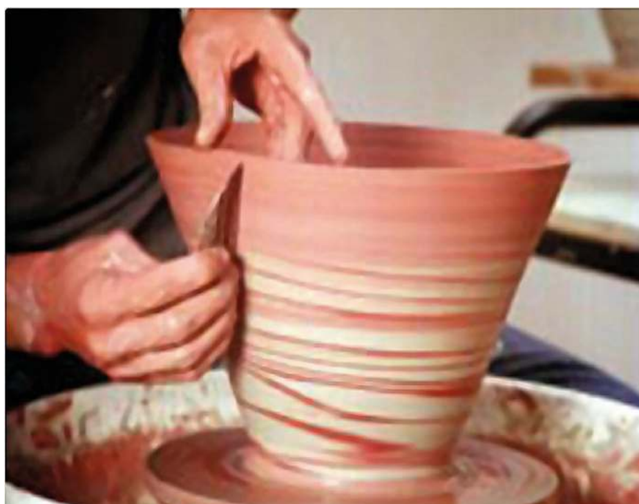
Imagen 30. Mezcla parcial de arcilla roja y loza. Neriage producido al torneear la pieza
