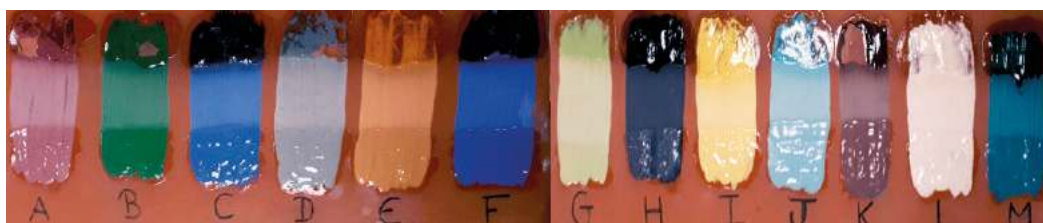
Imagen 106. Paleta de colores comerciales usados en el taller. Zona central con engobe puro. Arriba y abajo con aplicación de dos fritas diferentes. Alcalina y borácica, cuya reacción al color produce como resultado tonalidades distintas
