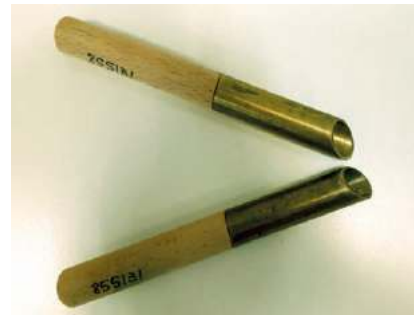
Imagen 44. Muestra de troqueles para perforar la arcilla
