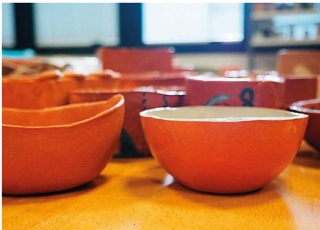
Imagen 141. Piezas sacadas del horno ya bizcochadas. El color ha cambiado, la arcilla es más rojiza y los engobes más intensos
