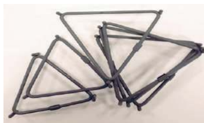
Imagen 41. Soportes metálicos de diferentes tamaños. Se usan en las cocciones de esmaltes y vidriados
