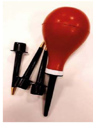
Imagen 36. Pera y boquillas para aplicación de esmaltes y engobes
