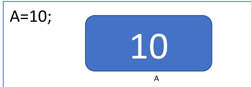
Figura 11. Ilustración sobre la operación de asignación. En el espacio de memoria reservada para A se almacena el valor de 10.
