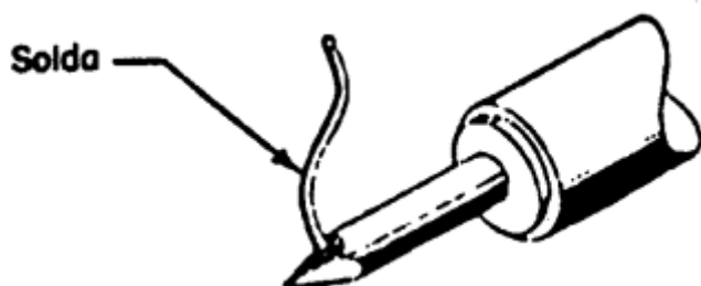
Figura 6-57 Estanhagem da ponta do ferro de soldar
