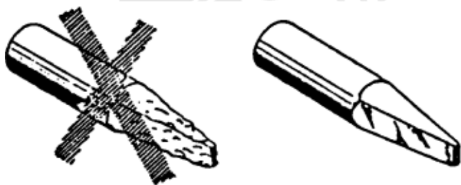
Figura 6-56 Limpeza da ponta do ferro de soldar
