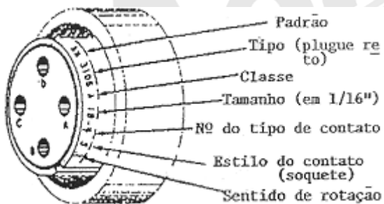
Figura 6-30 Codificação do conector AN
