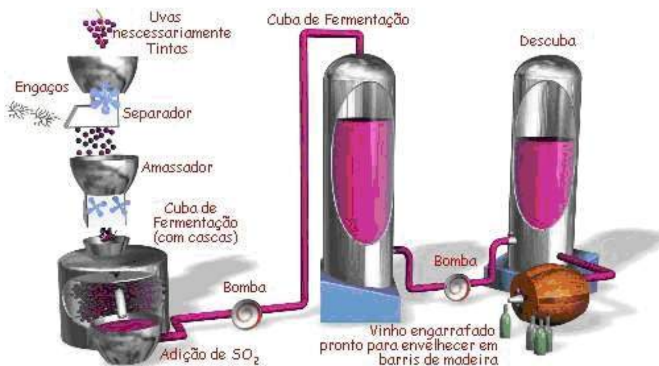
FIGURA 6 – Fluxograma da Produção de Vinho Tinto
