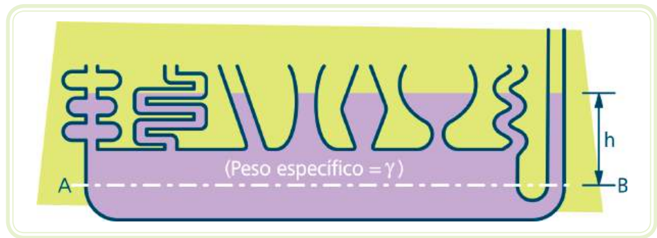
Figura 1.3: Distribuição de pressão em um mesmo plano horizontal para um fluido em repouso Fonte: CTISM
