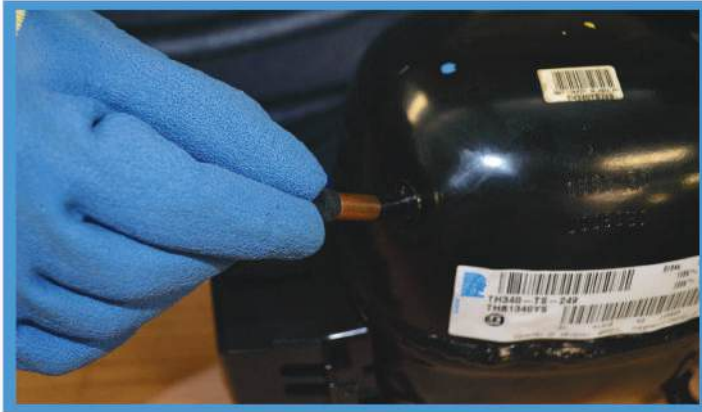
Figura 40. Tapones en los tubos del compresor
