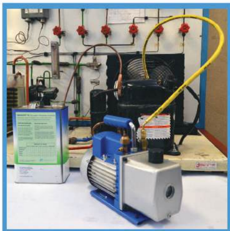
Figura 39. Llenado de aceite en compresor semihermético
