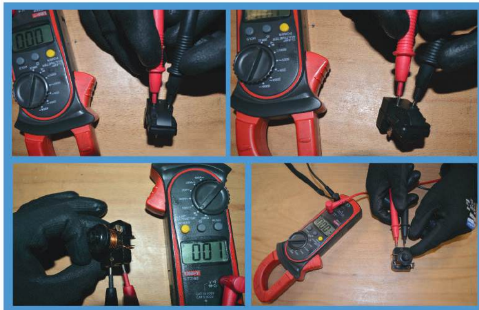
Figura 18. Prueba eléctrica Relé
