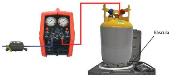
Figura 32. Arreglo de cilindro, báscula y unidad de recuperación para observación manual
