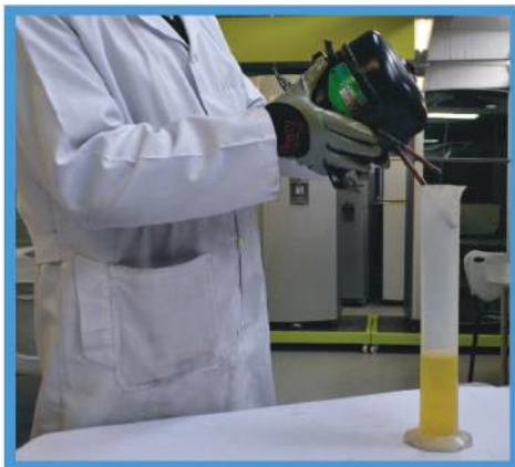
Figura 38. Extracción de aceite del compresor hermético (Izq.) y semihermético (Der.)
