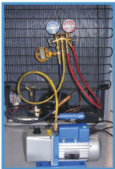
Figura 58. Conexión de la bomba de vacío al sistema
