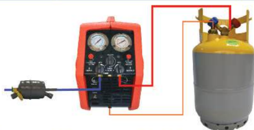
Figura 30. Recuperación con conexión de interruptor de flotación - OFP
