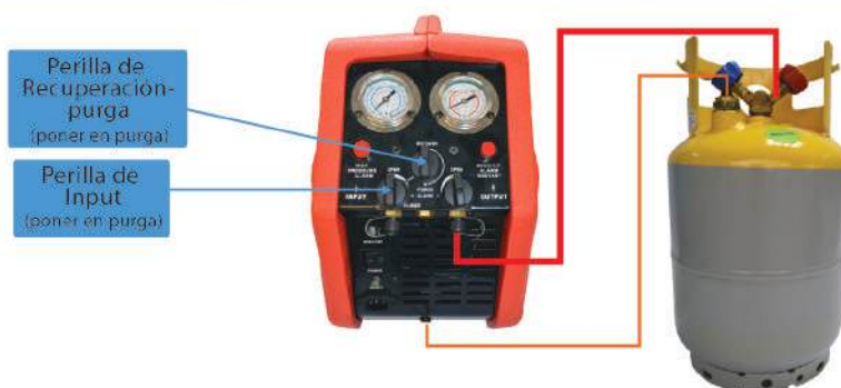
Figura 33. Extracción de residuos en recuperadora
