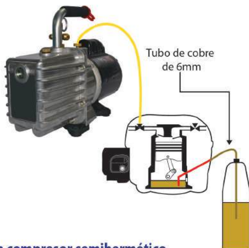
Figura 39. Llenado de aceite en compresor semihermético
