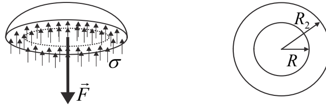
Figura 5.10: Tensão de esmagamento
