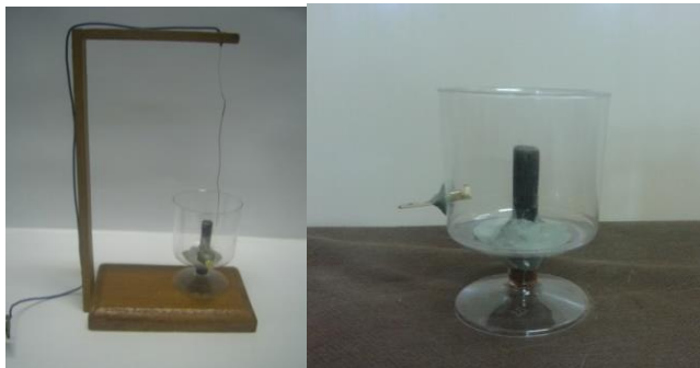
Figura 12. Dispositivo similar ao construído por Faraday. FONTE: VAZ (2013)
