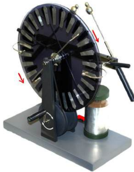
Figura 1.9.: Máquina de Wimshurst.
