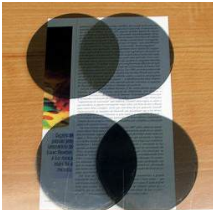
Figura 12.10.: Dois filtros polarizadores com os eixos paralelos (acima) e com os eixos perpendiculares (abaixo).
