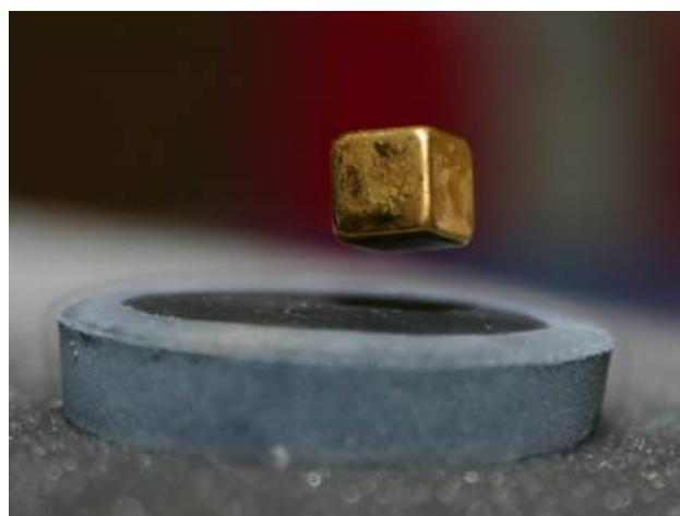
Figura 3.13.: Levitação magnética de um íman cúbico sobre um disco de material supercondutor.
