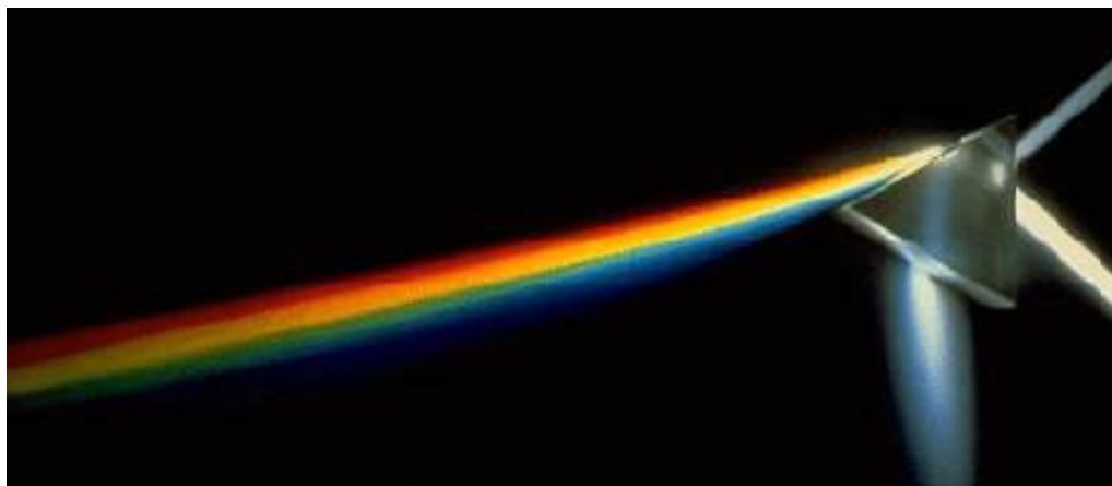
Figura 12.9.: Decomposição espectral da luz solar por um prisma.
