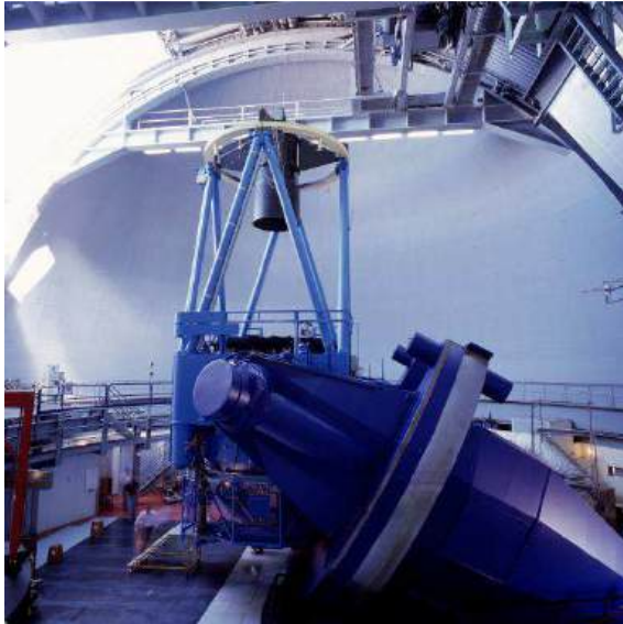
El telescopio de 3,60 m de ESO en Chile. Observe el eje inclinado de la montura ecuatorial alrededor del cual gira el instrumento. © ESO
