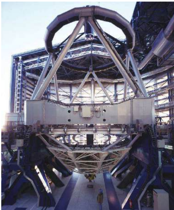
Uno de los cuatro telescopios del Very Large Telescope de ESO en Chile con su espejo de 8,20 m de diámetro que pesa 42 toneladas. © ESO
