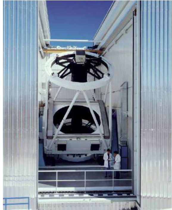
El telescopio de 3,50 m NTT de ESO en Chile sobre su montura azimutal. © ESO.
