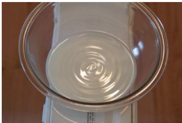
FIGURA 16.25 Las ondas estacionarias se forman en la superficie de un bol de leche ubicado en el marco de un ventilador cuadrado. Las vibraciones del ventilador hacen oscilar la superficie de la leche. Las ondas son visibles debido a la reflexión de la luz de una lámpara (créditos: David Chelton).
