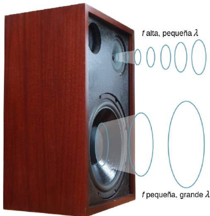
FIGURA 17.10 Como se desplazan a la misma velocidad en un medio determinado, los sonidos de baja frecuencia deben tener una mayor longitud de onda que los de alta frecuencia. Aquí, los sonidos de menor frecuencia son emitidos por el altavoz grande, llamado woofer, mientras que los sonidos de mayor frecuencia son emitidos por el altavoz pequeño, llamado altavoz de alta frecuencia (tweeter) (créditos: modificación de un trabajo de Jane Whitney).
