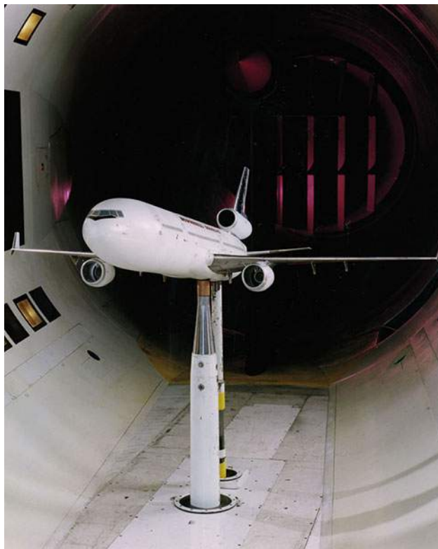
FIGURA 6.30 Investigadores de la NASA prueban un modelo de avión en un túnel de viento (créditos: NASA/Ames).
