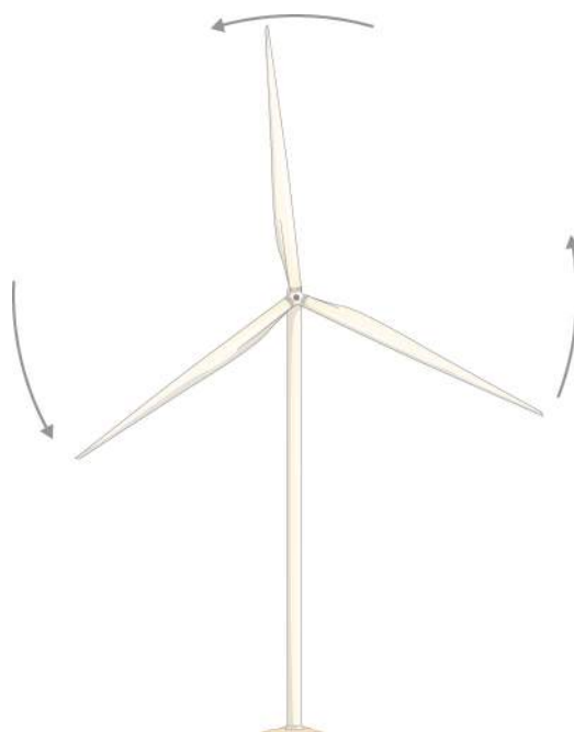
FIGURA 10.10 Aerogenerador que rota en sentido contrario a las agujas del reloj, visto de frente.
