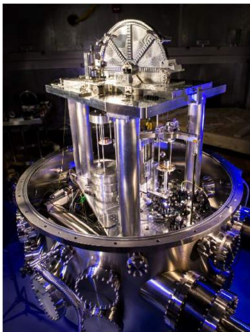
FIGURA 1.10 Redefinición de la unidad de masa del SI. La balanza Kibble del Instituto Nacional de Estándares y Tecnología de los EE. UU. es una máquina que equilibra el peso de una masa de prueba con la corriente eléctrica resultante necesaria para una fuerza que la equilibre.
