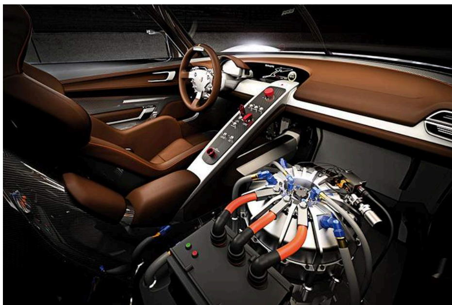
FIGURA 10.18 Volante de inercia del sistema de recuperación de energía cinética (Kinetic Energy Recovery System, KERS) utilizado en los autos (créditos: "cmonville"/Flickr).
