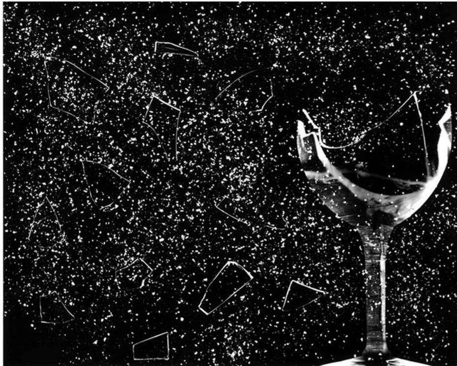
FIGURA 17.2 Esta copa la destrozó una onda sonora de alta intensidad de la misma frecuencia que la frecuencia de resonancia de la copa (créditos: “||read||”/Flickr).
