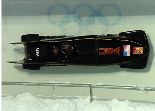
FIGURA 6.29 Desde los autos de carreras hasta los corredores de trineo, la forma aerodinámica es crucial para alcanzar velocidades máximas. Los trineos de carreras están diseñados para la rapidez y tienen forma de bala con aletas cónicas (crédito: "Ejército de los EE. UU."/Wikimedia Commons).
