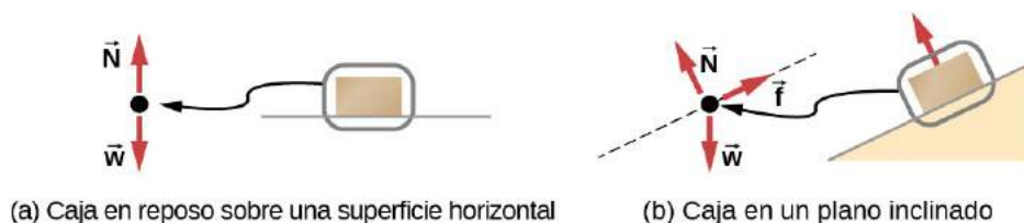
FIGURA 5.4 En estos diagramas de cuerpo libre, \vec{N} es la fuerza normal, \vec{w} es el peso del objeto, y \vec{f} es la fricción.
