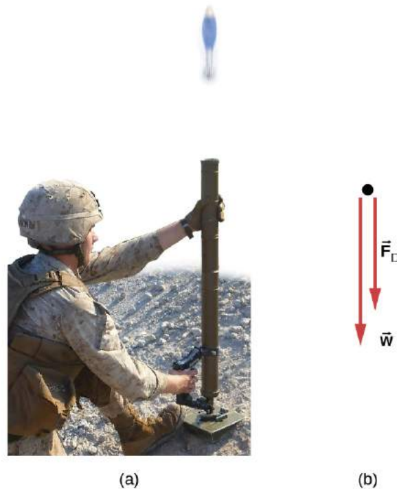
FIGURA 6.9 (a) El mortero dispara un proyectil en línea recta hacia arriba; consideramos la fuerza de fricción proporcionada por el aire. (b) Se muestra un diagrama de cuerpo libre que indica todas las fuerzas sobre el proyectil de mortero (créditos: a. modificación del trabajo de OS541/DoD. La información visual del Departamento de Defensa (Department of Defense, DoD) de los EE. UU. no implica ni constituye el respaldo del DoD).
