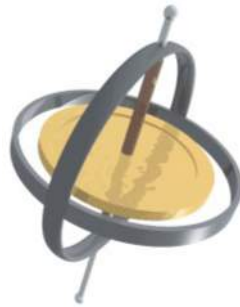
FIGURA 11.19 Un giroscopio consiste en un disco que gira en torno a un eje, el cual adopta libremente cualquier orientación.
