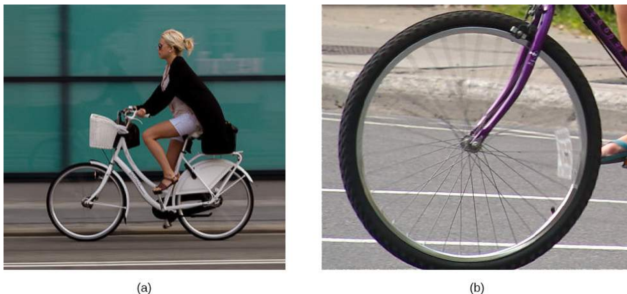
FIGURA 11.2 (a) La bicicleta avanza y sus neumáticos no resbalan. La parte inferior de la rueda ligeramente deformada está en reposo con respecto a la superficie de la carretera durante un tiempo medible. (b) Esta imagen muestra que la parte superior de una rueda rodante aparece borrosa por su movimiento, pero la parte inferior está
