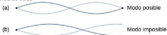
FIGURA 16.31 (a) La figura representa el segundo modo de la cuerda que satisface las condiciones de frontera de un nodo en cada extremo de la cuerda. (b) Esta figura no podría ser un modo normal en la cuerda porque no satisface las condiciones de frontera. Hay un nodo en un extremo, pero un antinodo en el otro.
