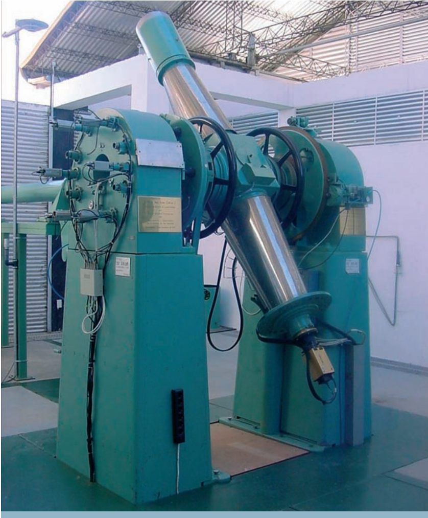
En la figura se muestra el círculo meridiano automático de San Fernando instalado en el Observatorio de San Juan (Argentina). El círculo meridiano es uno de los instrumentos más precisos empleados para la determinación de las coordenadas celestes de los astros. Créditos: Real Instituto y Observatorio de la Armada.
