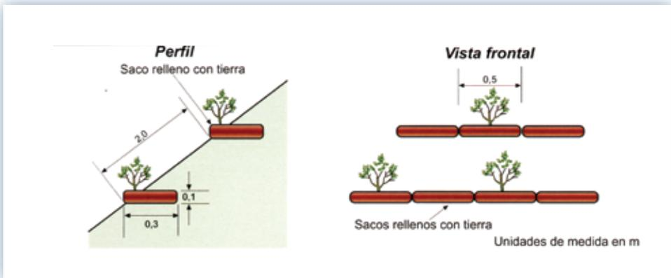
**Figura 19.** Esquema de construcción de presas con sacos o geotextil, tomado de Francke et ál. (2004).
