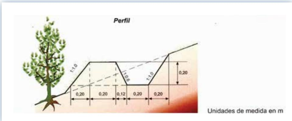
**Figura 15.** Esquema de construcción de la zanja de infiltración, tomado de Francke et ál. (2004).
