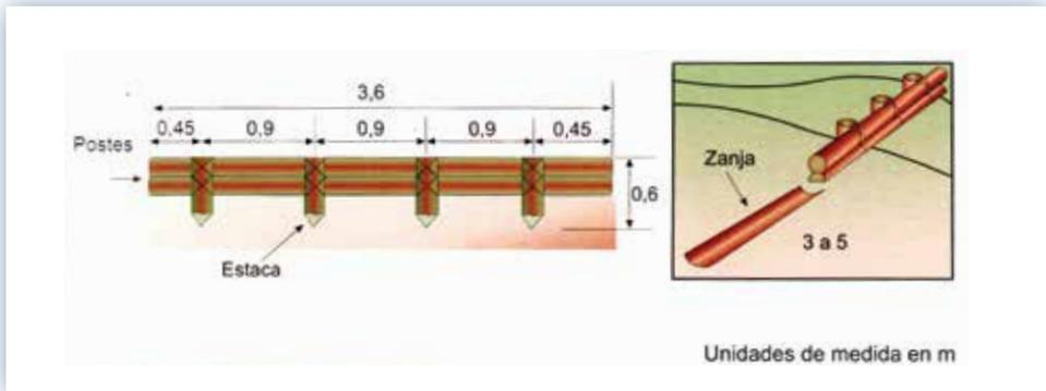
**Figura 14.** Esquema de construcción del canal transversal simple, tomado de Francke et ál. (2004).
