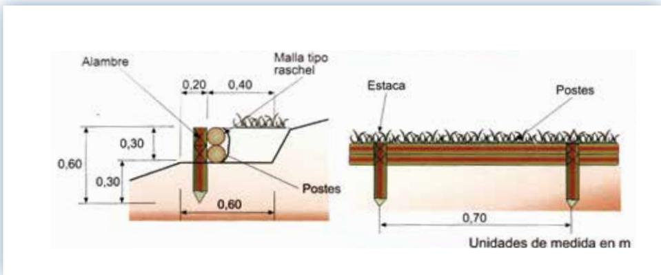
**Figura 17.** Esquema de construcción de presas con postes o tronco de madera, tomado de Francke et ál. (2004).
