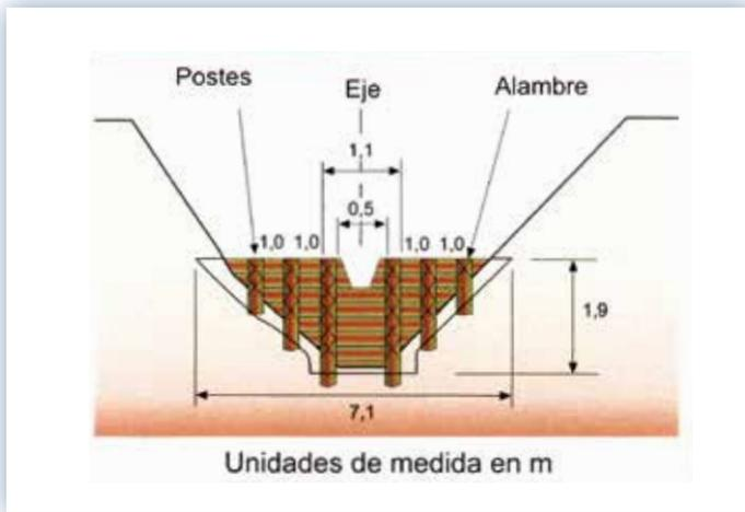
**Figura 21.** Esquema de construcción de diques con postes o troncos de madera, tomado de Francke et ál. (2004).
