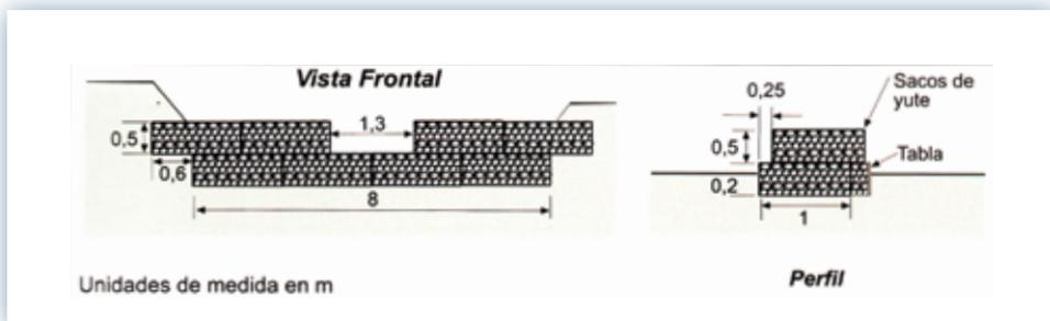
**Figura 22.** Esquema de construcción de diques con estructura gavionada, tomado de Francke et ál.(2004).
