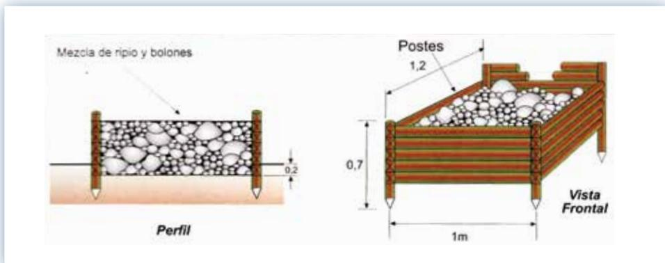
**Figura 23.** Esquema de construcción de disipadores de corriente, tomado de Francke et ál. (2004).
