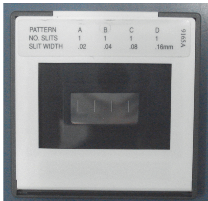
Figura 5.4 Fotografia das fendas utilizadas nos experimentos apresentados neste capítulo.
