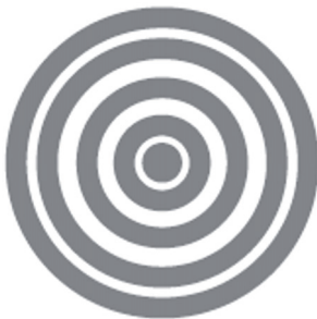
Figura 9.4 Representação das franjas de interferência observadas no interferômetro de Michelson.
