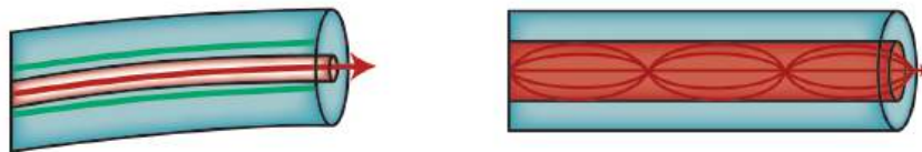
Figura 1.14: Fibra monomodo e multimodo
