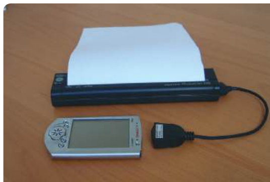
Figura 6.2: Dispositivo e impressora conectados por infravermelho
